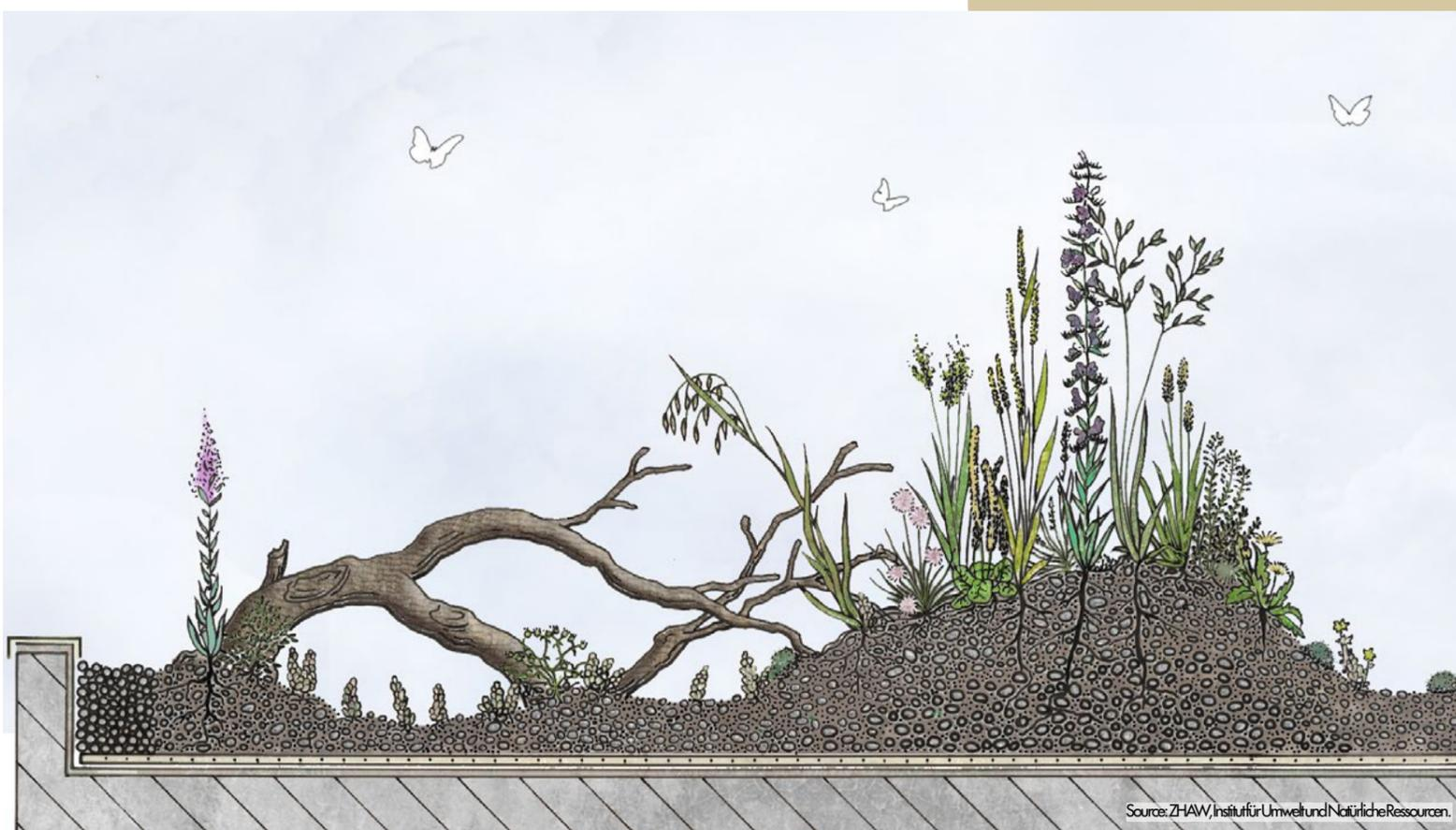
Coupe de principe (hors-échelle) d'une toiture végétalisée extensive, avec micro-topographie et bois sec pour les insectes.
